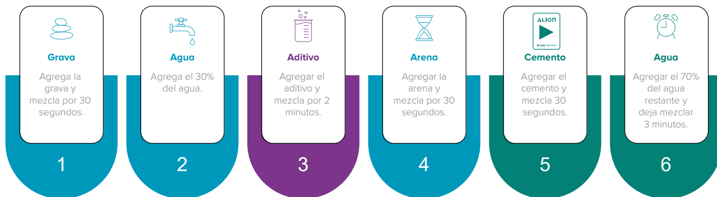
Figura 17: Secuencia de mezclado de los materiales para la producción de concreto
