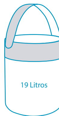
Figura 14: Baldes para la dosificación de concreto
