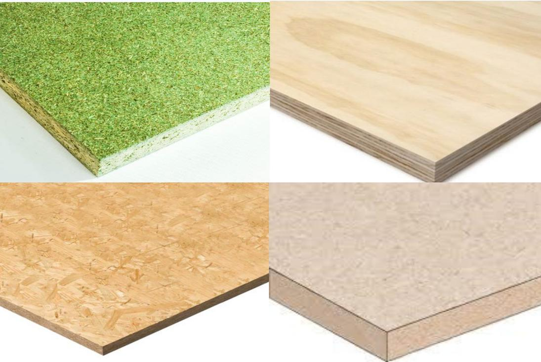
Formaleta madera aglomerada, contrachapada, OSB y MDF: acabado superficial homogéneo, liso, menos durable que la formaleta metálica, susceptible a humedad.
