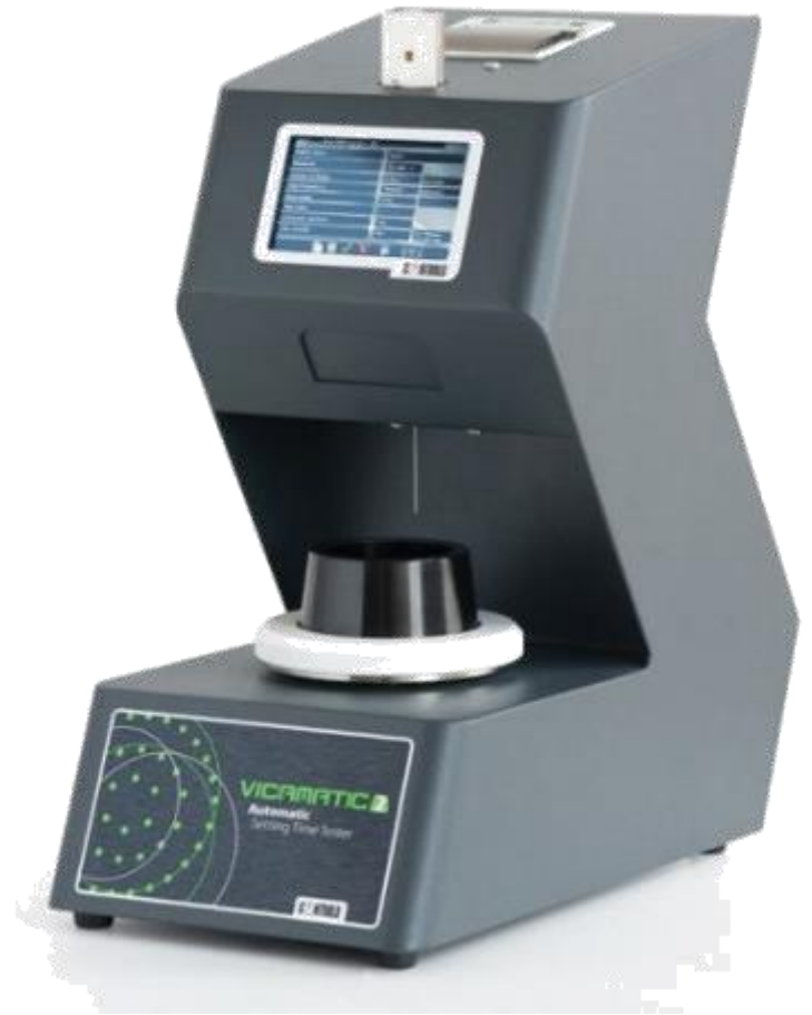
Vicat automatizado para determinar la consistencia y tiempo de fraguado
